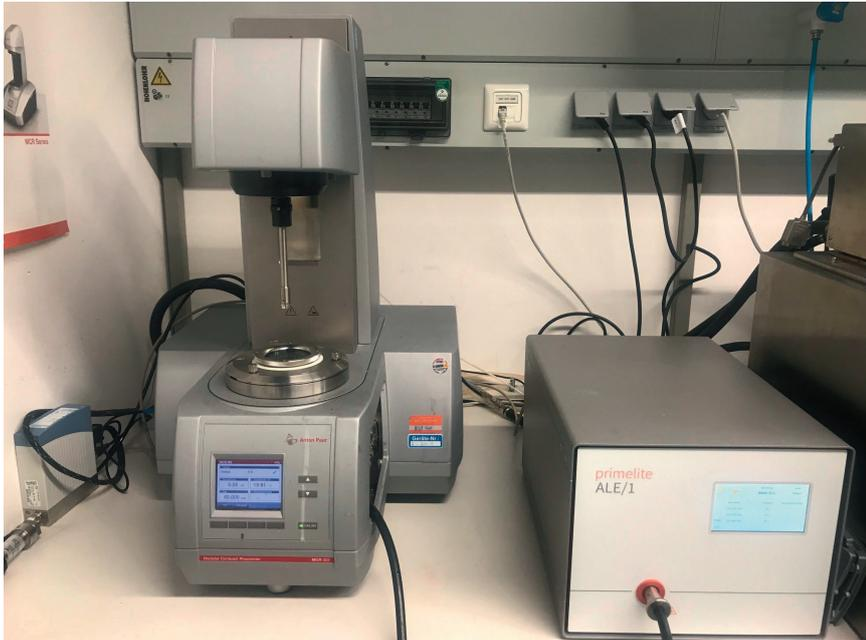
**Bild 1.** Für die Untersuchungen kam ein UV-Rheometer (links) und unter anderem die Belichtungseinheit Ale 1.3 (rechts) zum Einsatz. © EZD
